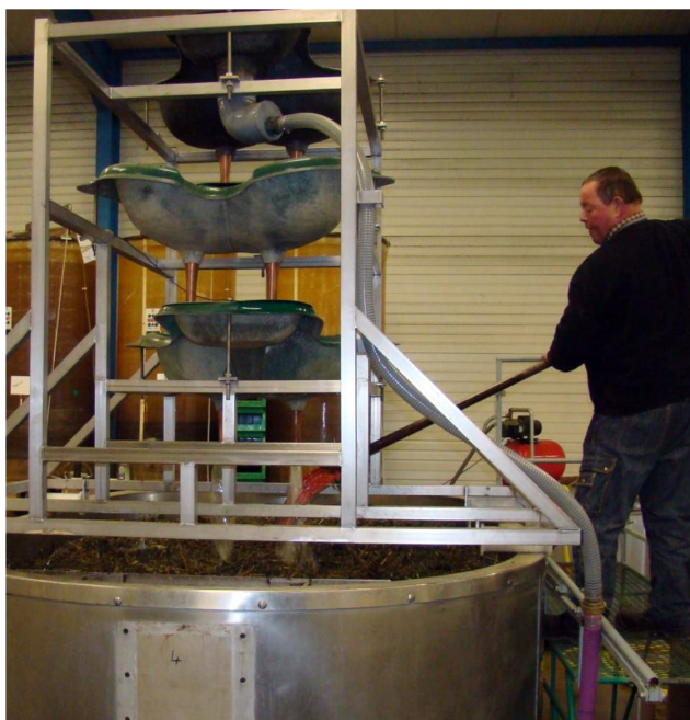
Remplissage de cuves avec l'eau de pluie avec Dynam'O (trois vasques) sur cuves pour tisanes et macérations.
